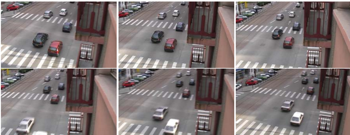
FIG. B.1 – Un sous-ensemble des 60 images de la séquence vidéo de la route. La modélisation de la géométrie d'images fournies par une caméra en mouvement observant une route est une des applications du scénario considéré. Les difficultés pour la reconstruction 3D à partir d'une telle séquence proviennent du fait que la scène contient des primitives statiques et dynamiques, et qu'il n'y pas de contrainte sur le mouvement inconnu de la caméra.
