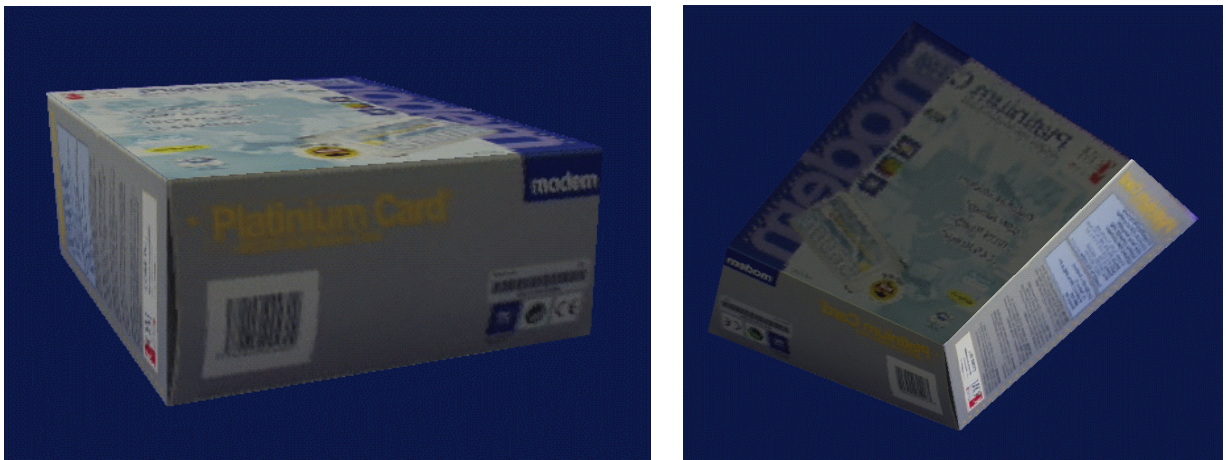
FIG. A.9 – Modèle obtenu pour le modem, (a) montre la reconstruction éparsée contrainte par les plans et (b) montre le modèle 3D consistant de 3 plans délimités et des deux caméras. On observe en (a) que les points reconstruits sont parfaitement coplanaires.
