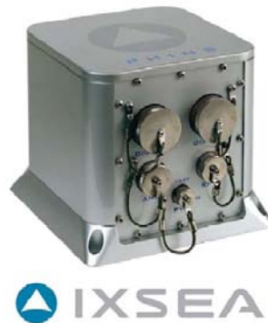
FIGURE 1.4 – Centrale de navigation à guidage inertiel PHINS de la société IXSEA.
