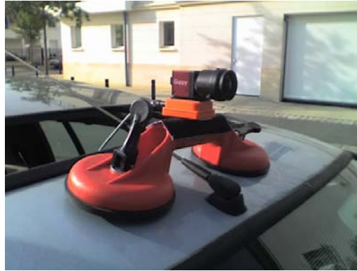
FIGURE 5.22 – Photographie du dispositif de localisation ici placé sur un véhicule. Ce dispositif est composé de la caméra basse résolution AVT GUPPY et de la centrale inertielle XSENS-MTx.
