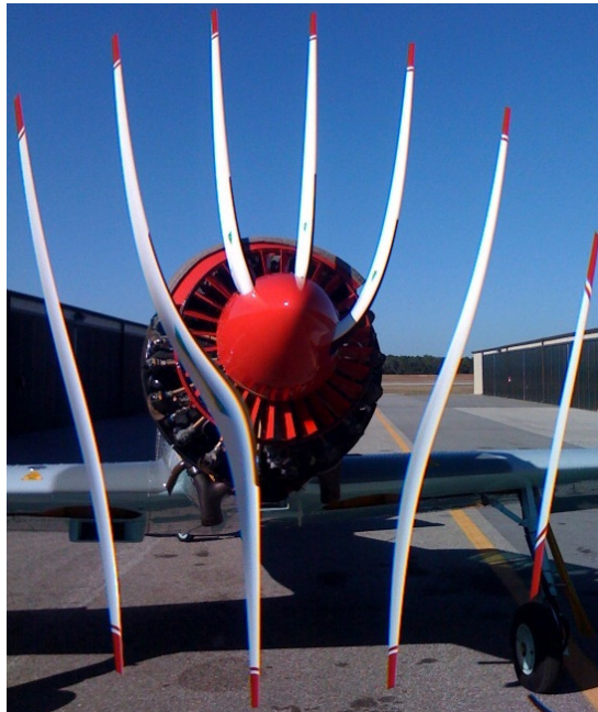
FIGURE III.11 – Une rotation extrêmement rapide peut entraîner des disparitions et réapparitions de points de manière surprenante. Cette hélice d'avion n'a bien évidemment pas autant de pales que l'image en contient, et elles sont bien toutes attachées à l'avion. Photographié par Derek Sine.
